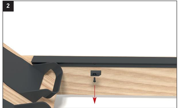
2 Lösen und entfernen Sie nun die Sitzstopper aus den Schienen. Benutzen Sie hierfür einen Inbusschlüssel.
