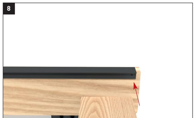
8 Sobald die Laufschiene passend sitzt, schrauben Sie die Sitzstopper (aus Schritt 2) wieder an.
