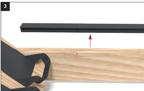
3 Nehmen Sie nun die Kunststoff-Laufschiene von der Holzschiene. Die Kunststoff-Laufschiene kann sehr fest sitzen, benutzen Sie ggfs. einen Schraubendreher o. ä. zum Hebeln.
