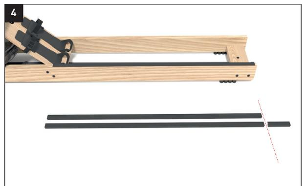
4 Legen Sie die defekte Laufschiene neben die neue. Kürzen Sie die neue Laufschiene auf Länge der defekten Laufschiene ein. Benutzen Sie hierfür eine Eisensäge bzw. eine Bügelsäge oder ein scharfes Cutter-Messer.
