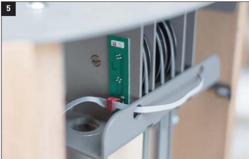
Anschließend befestigen Sie den 6-poligen Stecker an der linken (L) Platine. Beachten Sie auch hier den Verdrehenschutz.
