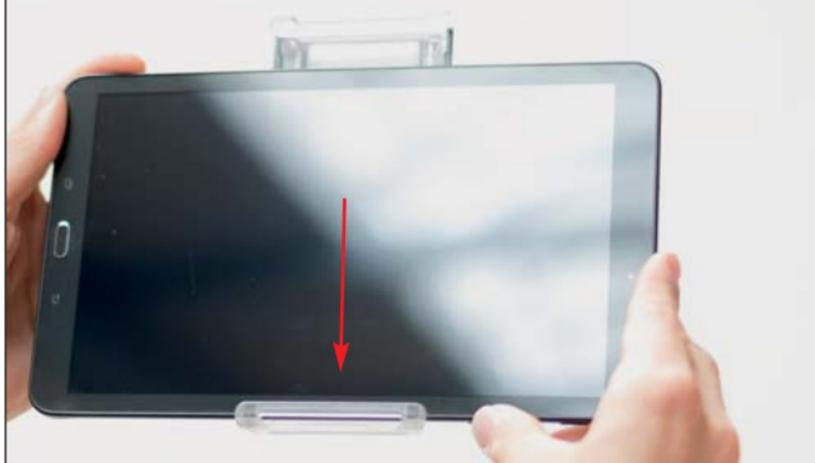
Drücken Sie das Tablet nun leicht herunter, so dass Sie die obere Halterung befestigen können.
