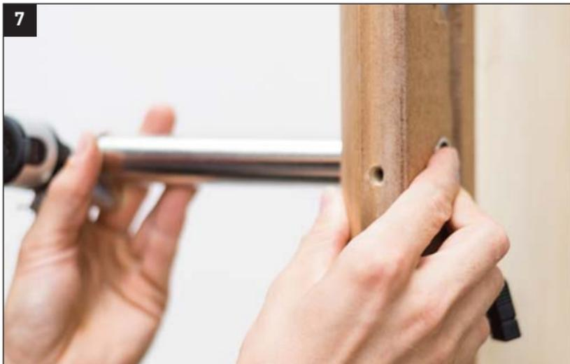
Führen Sie nun die Tablethalterungs-Stange samt USB-Kabel so ein, dass sich die Stange durch das Loch im Korpus verschrauben lässt.
